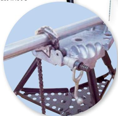
El modelo trípode **R450C** viene con mordazas reversibles de acero inoxidable con dientes normales en un lado y mordazas recubiertas de goma en el otro. Tiene una base de aluminio anodizado resistente a la corrosión, junto con un tubo deslizante de polímero transparente para no estropear el tubo. (El tubo deslizante cubre la cadena, pero se retira fácilmente). El lubricante de la cadena es de calidad alimentaria, no a base de petróleo.
